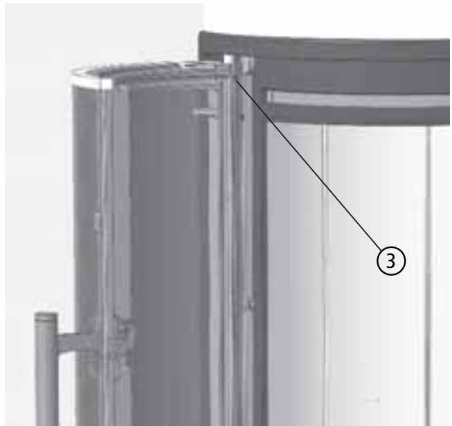
Abb. 3.8 Madenschraube, Stiftsicherung lösen
