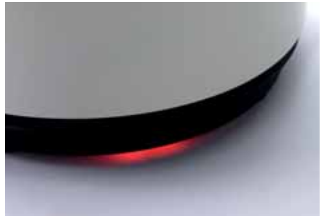
Abb. 4.29 LED-Lichtsignal „ROT blinkend“ - auch nach Abbrandende
