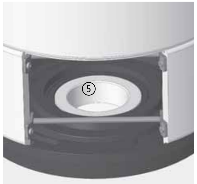
Abb. 3.34 Verbrennungsluftstutzen, nach unten
