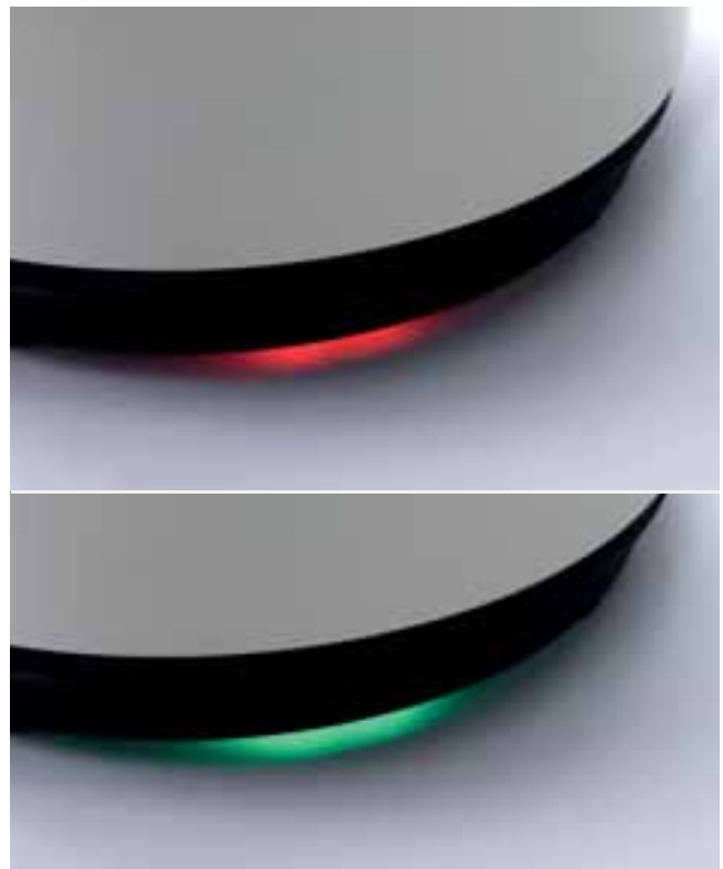
Abb. 4.28 LED-Lichtsignal bei Betrieb „ROT“ dann wieder „GRÜN“
