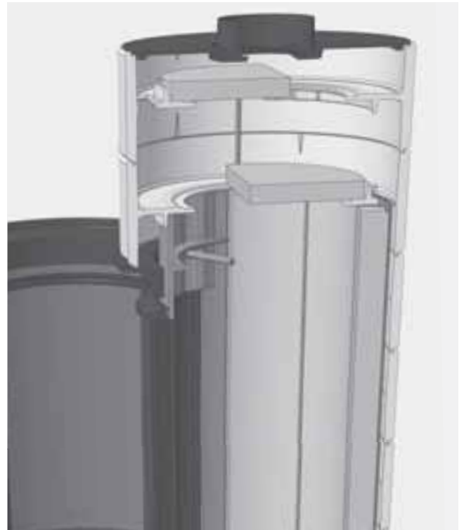
Abb. 4.36 Entnehmen der Umlenkungen (Heizgasführung)
