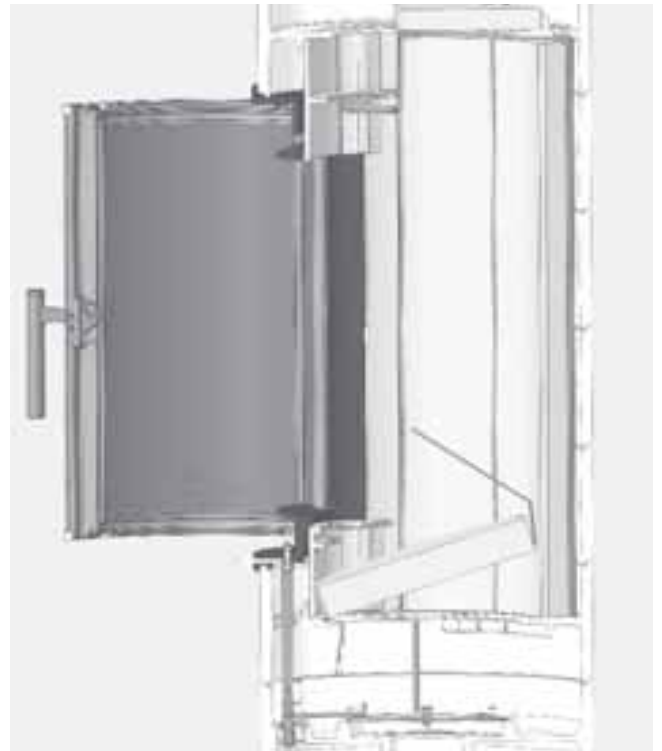
Abb. 4.30 Anheben des Bodensteins im Brennraum
