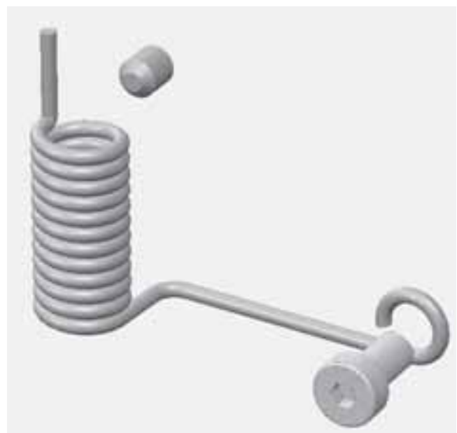
Abb. 3.11 Türfeder, Madenschraube und Spannschraube
